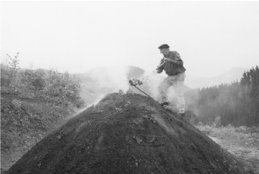
Fig. 6.- Introducción de brasas por la chimenea con la ayuda de una pala.
